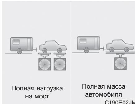
Вес дышла прицепа должен составлять не более 10% от полного веса загруженного прицепа, в пределах максимальной нагрузки на дышло прицепа. После загрузки прицепа, взвесьте его и отдельно измерьте опорную нагрузку от дышла, чтобы убедиться в правильности распределения веса. Если распределение веса неправильное, его можно просто изменить, передвинув некоторые предметы в прицепе.
