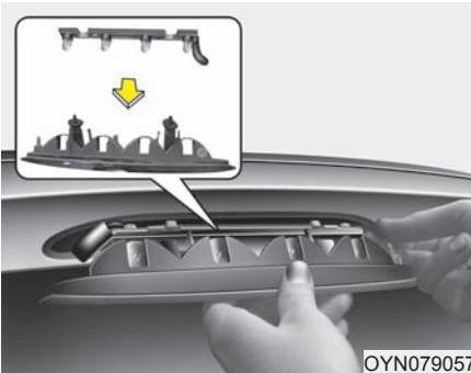
3. Снимите узел внутреннего освещения и отсоедините электрический провод лампочки.
