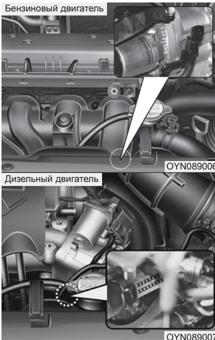
Серийный номер двигателя выбит на блоке цилиндров, как показано на рисунке.
