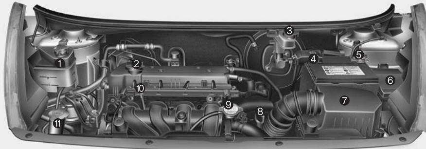
1. Бачок расширительный для охлаждающей жидкости
