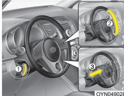
Чтобы изменить наклон рулевой колонки, опустить рычаг фиксатора (1), отрегулировать положение рулевой колонки на нужный угол по высоте (2) и боковому положению (3), затем поднять рычаг фиксатора, чтобы закрепить новое положение рулевой колонки. Перед началом движения следует убедиться, что рулевая колонка находится в нужном положении.
