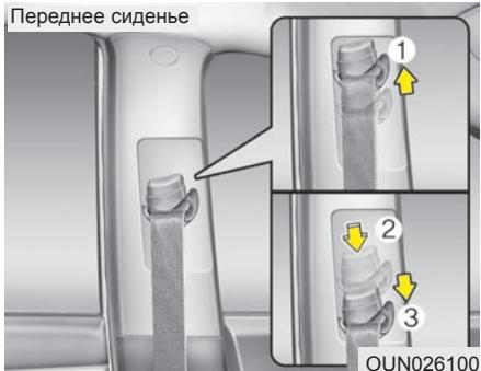
Можно установить верхнюю точку крепления ремня безопасности в одном из 4 возможных положений для достижения максимального удобства и безопасности.
