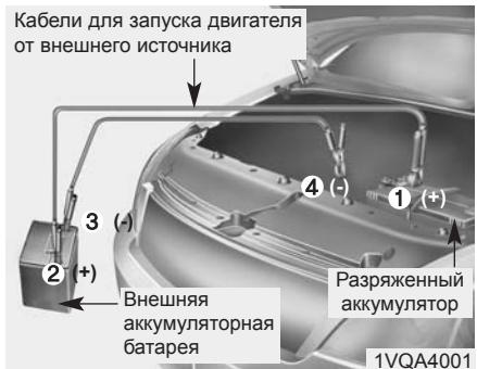
Подключайте кабели в прямой последовательности нумерации, а отсоединяйте - в обратной.
